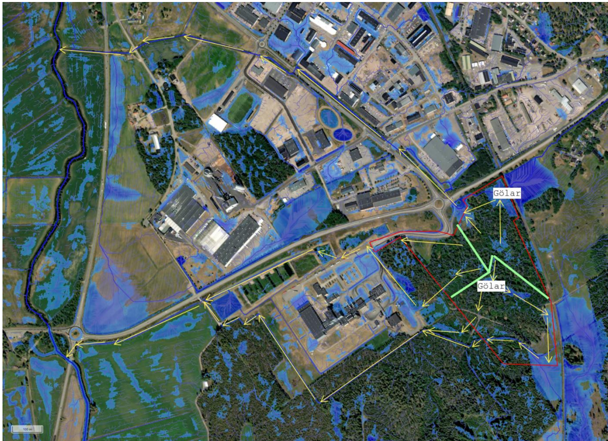
Figur 2. Flödesvägar och översvämningsområdena framtagen i Scalgo Live 2021. Röd linje är ungefärlig avgränsning för planområdet, gröna linjer är ungefärliga vattendelare och gula pilar är ytvattnets flödesvägar.
