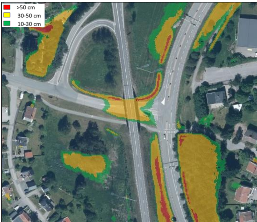
Figur 14. Översvämningrisk under vägbro för väg 23. Verktöget baseras på nationella höjddata - Markhöjdmodell, grid 1+ (2022-06-07). Källa: Lantmäteriet hämtat från SCALGO Live (2023).
