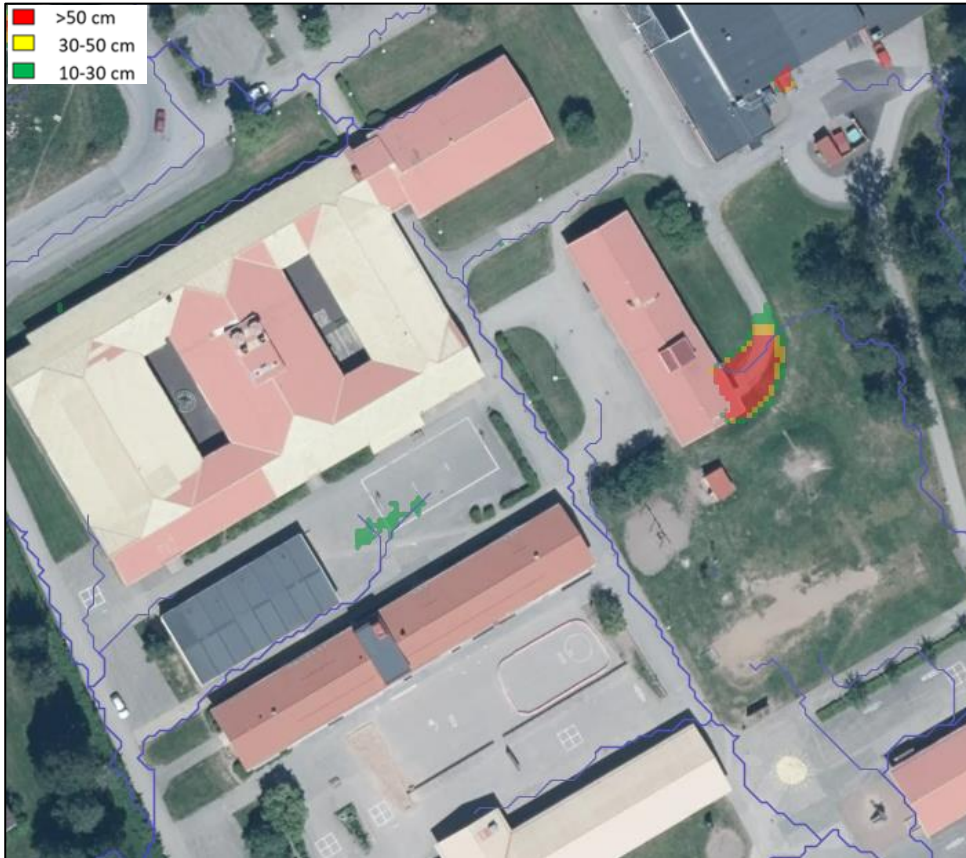
Figur 30. Översvämmade ytor och flödesvägar vid en skola vid ett 100-årsregn med klimatkfaktor 1,4 (83 mm). Källa: Verktöget baseras på nationella höjddata - Markhöjdmodell, grid 1+ (2022-06-07). Källa: Lantmäteriet hämtat från SCALGO Live (2023).
