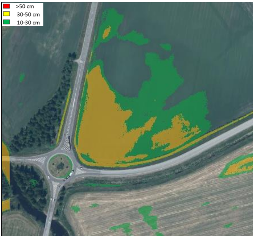
Figur 15. Översvämningsrisk vid rondellen för väg 40/23. Verktöget baseras på nationella höjddata - Markhöjdmmodell, grid 1+ (2022-06-07). Källa: Lantmäteriet hämtat från SCALGO Live (2023).
