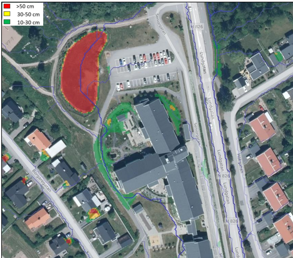
Figur 31. Översvämmade ytor och flödesvägar vid ett vårdboende vid ett 100-årsregn med klimatkfaktor 1,4 (83 mm). Verktuget baseras på nationella höjddata - Markhöjdmodell, grid 1+ (2022-06-07). Källa: Lantmäteriet hämtat från SCALGO Live (2023).
