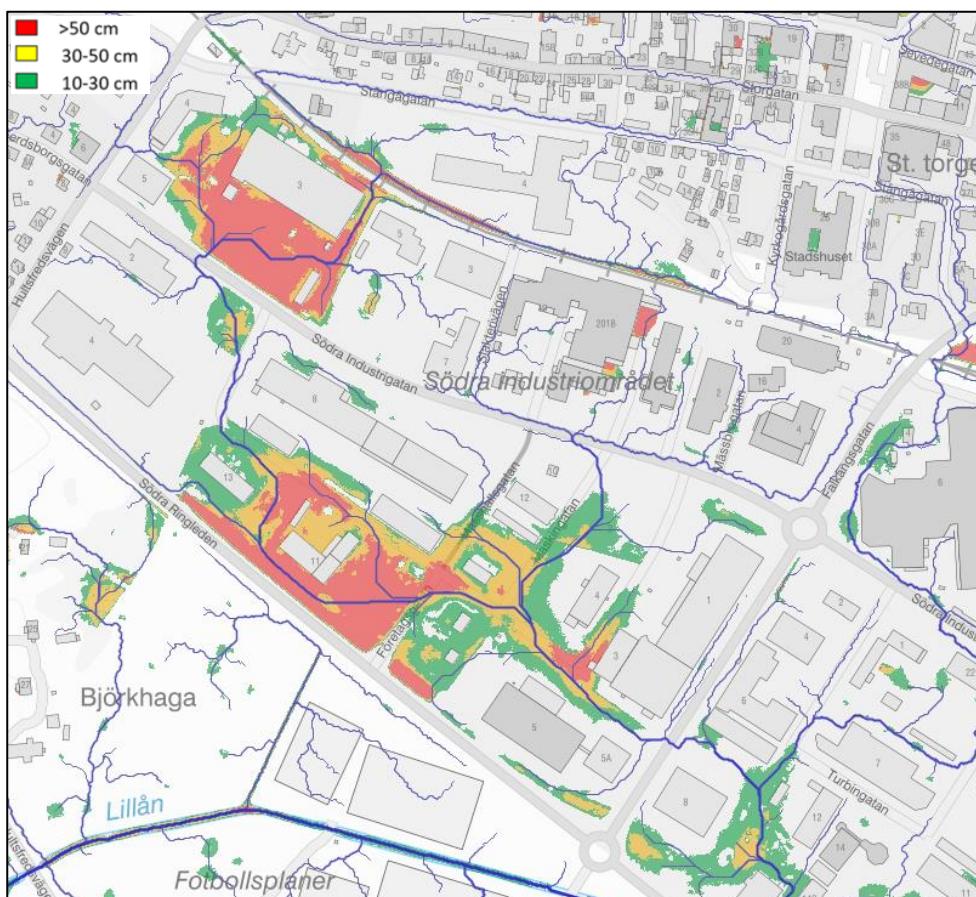
Figur 22. Översvämmade ytor och flödesvägar vid Riskområde 2 vid ett 100-årsregn med klimattfaktor 1,4 (83 mm). Verktöget baseras på nationella höjddata - Markhöjdmodell, grid 1+ (2022-06-07). Källa: Lantmäteriet hämtat från SCALGO Live (2023).
