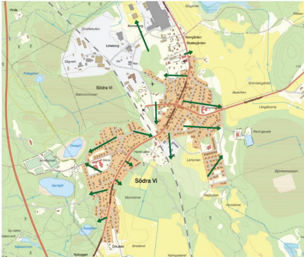
Figur 7. Översiktlig dagvattenavledning i Södra Vi.
